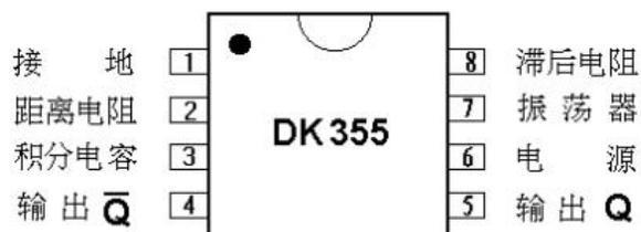
DK355 具备电感式接近开关设计所需的全部功能。
